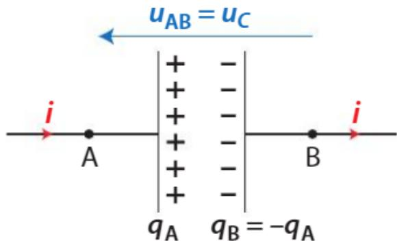
L'aptitude d'un condensateur à accumuler sur ses surfaces conductrices un grand nombre de charges électriques est appelée capacité. Notée C (F), elle caractérise un condensateur et s'exprime en Farad.
