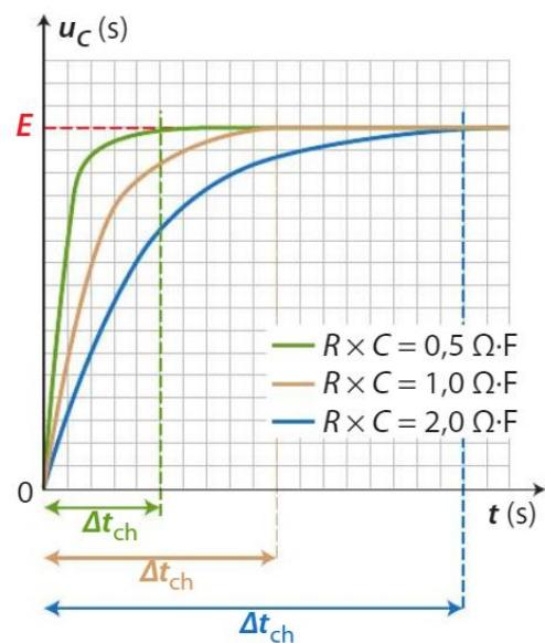
En effet, la solution de l'équation différentielle montre que pour une durée de  $5\tau$ , la tension  $u_C$  atteint sa valeur finale ( $E$  en charge ou  $0 \text{ V}$  en décharge) avec un écart de moins de 1 %.
