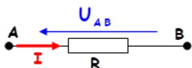
**Remarque:** Par convention, dans le cas d'un récepteur, le courant "descend" les potentiels.
