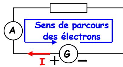
Le sens du courant électrique est donc opposé au sens de déplacement des électrons
