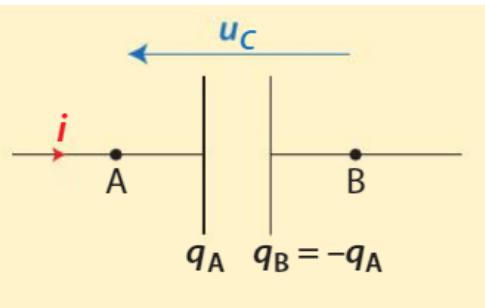
De plus, l'intensité  $i$  du courant est la dérivée de la charge électrique  $q_A$  rapport au temps:
